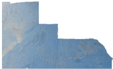
Fotografía No.8: Hélice HK-2252, con evidencias de baja potencia al momento del impacto
