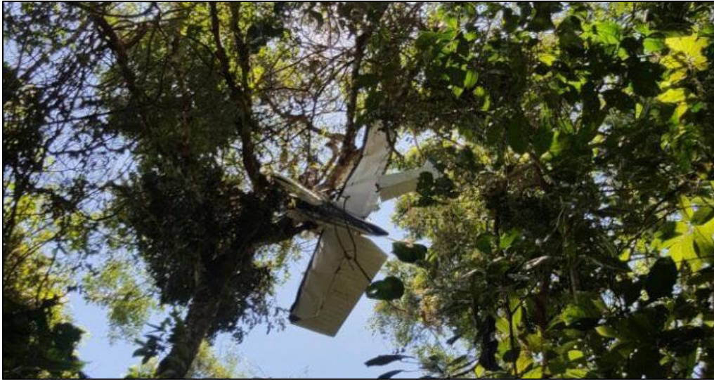
Fotografía No.2: Posición final del empenaje de la aeronave HK-2252
